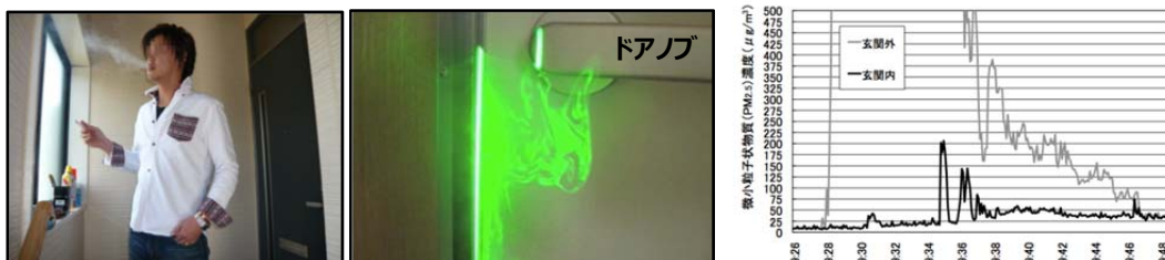
図 5.4.4. 玄関先で喫煙した際のリビングの汚染(受動喫煙)と煙の流入経路
